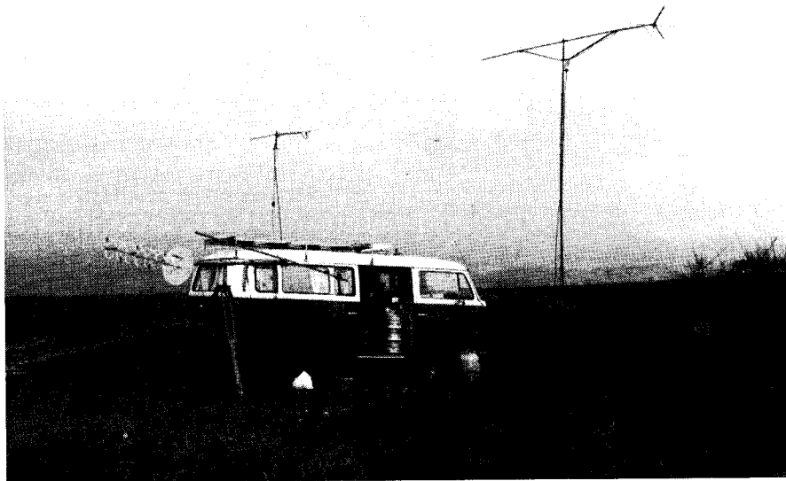
Het DX-'peditiestation FoGCS. Hier ziet u de tien jaar oude Volkswagenbus opgesteld in vak XI 69 b in Bretagne, op de Menez Hom, 330 meter boven zeeniveau. De antenne links van de auto wordt gebruikt voor OSCAR-verbindingen.
